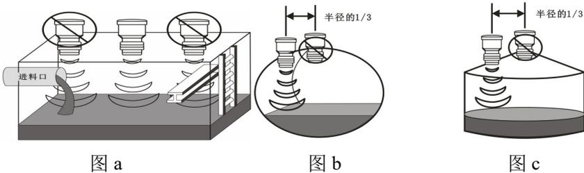
(3)探头可以选择用法兰或是标准的 M60×2 螺纹安装（安装接口与实物为准）。无论是法兰安装或是螺纹安装，或是有无选择锥筒，应该保证探头的底部突出过程接口的底部。图 c 说明了正确的安装方法。
