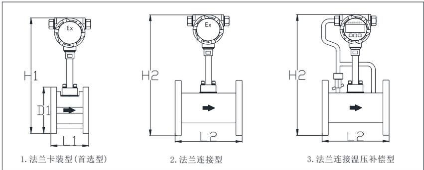
图 1 涡街流量计外形结构示意图
