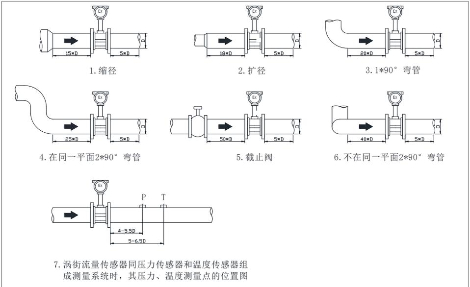
图 2 涡街流量计上下游最小直管段长度
