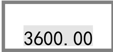
可以通过数字增加键 ↑、移位键→ 修改、设置最大六位整数两位小数的仪表系数。确认输入无误后按功能键 Z 置入参数。仪表系数置入范围 0.00-999999.99。
