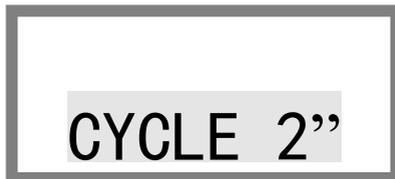
它们分别代表 10 秒、5 秒、2 秒采样时间。选择合适的采样时间后，按功能键 Z 确认。采样时间越短，电池寿命越短。所以在一般场合应选择最大采样时间 10 秒。
