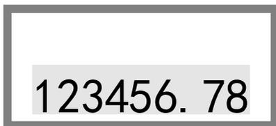
可以通过数字增加键↑、移位键→任意修改、设置六位整数，两位小数满度流量上限数值。确认输入无误后，按功能键 Z 置入参数。（脉冲输出或无电流输出时可不设置此参数）连续显示。
