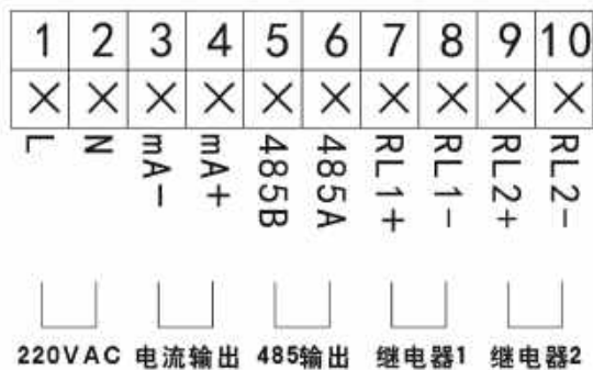
图 40 四线制 220VAC 电气连接图
