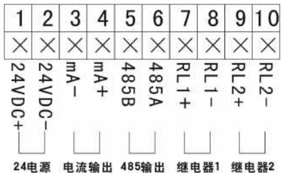
图 39 四线制 24VDC 供电接线图
